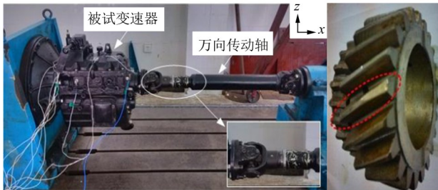
图9 汽车5挡变速器试验平台及故障齿轮
